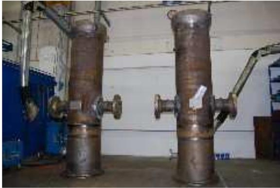
Scambiatori BEU in acciaio al carbonio, fascio tubiero con tubi a "U", spessore fasciame 25 mm.
