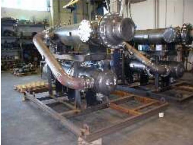
Installazione presso vetreria francese, portata d'aria 14.400 m<sup>3</sup>/h alle condizioni di 6 bar<sub>g</sub> e temperatura ambiente da 6 a 50 °C
