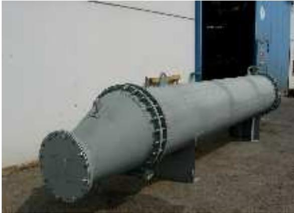
Gruppo scambiatore per trattamento aria WE6400/SP, a fascio estraibile, pressione di progetto 10 bar<sub>g</sub>, n° 806 tubi inox lisci diam. est. 18 mm s = 1.5 mm tipo seamless ASTM A213 304-304L, lunghezza tubi = 4700 mm, fasciame diam. est. = 812 mm.
